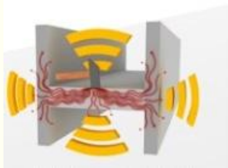
Obr. 11.92 Šírenie zvuku konštrukciou pred úpravou a po úprave izoláciou (Isover, 2023)
